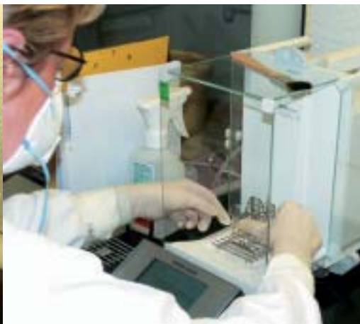
La balance XS205DU se nettoie rapidement et facilement en ouvrant la cage des deux côtés puis en retirant la grille de pesage et le pare-brise.
