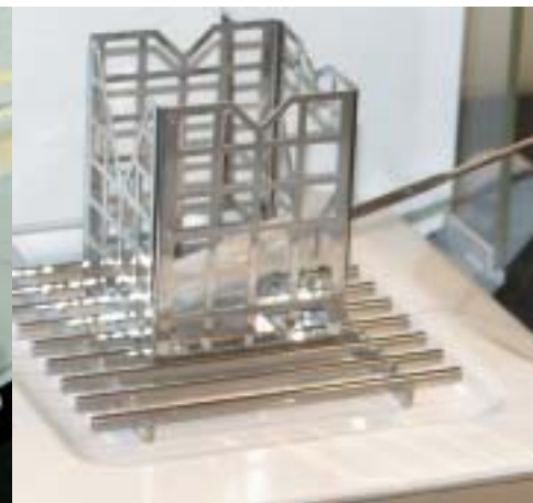
La cage évite que l'échantillon ne soit contaminé par des charges électrostatiques. C'est une solution simple, sûre, et qui fonctionne !
