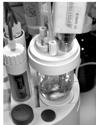
Fig 1: Homogénéisateur sur un titrateur DL38 Karl Fischer
