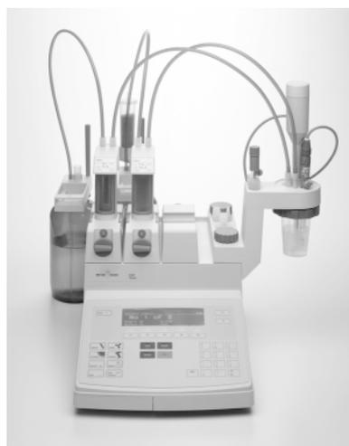
Fig. 1: Titrateur METTLER TOLEDO DL58
