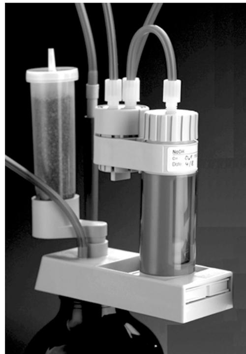
Fig. 2: Flacon de solution titrante protégé des effets du  $\text{CO}_2$  par un produit d'absorption.
