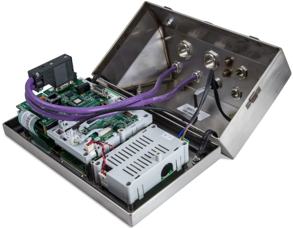
Figura 2-56: Collegamento del cavo PROFIBUS all'armadietto per ambienti difficili
