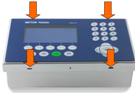
Figura 2-7: Conexión de los cuatro sujetadores de resorte
