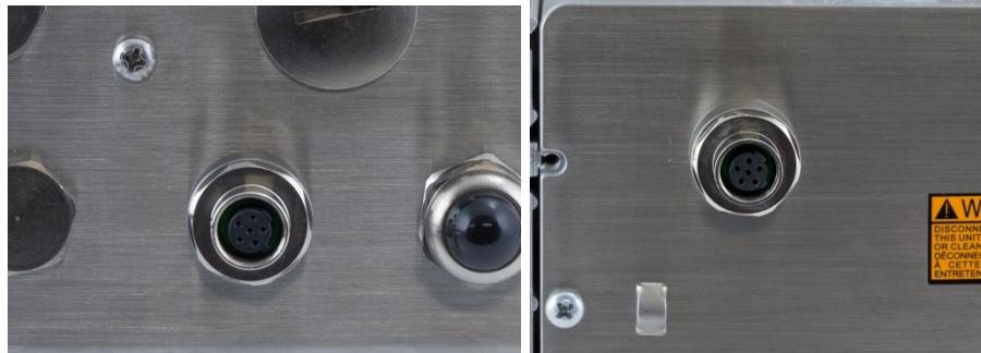
Figura 2-31: Ubicación del conector SICSpró en las cajas para ambientes adversos (izquierda) y montaje en panel (derecha)
