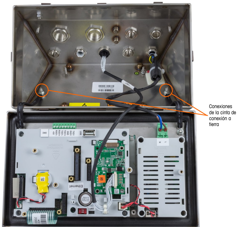
Figura 2-13: Para aflojar las cintas de conexión a tierra
