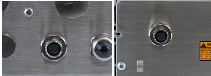
Figura 2-31: Posizione del connettore SICSpr sugli armadietti per ambienti difficili (sinistra) e con montaggio a pannello (destra)
