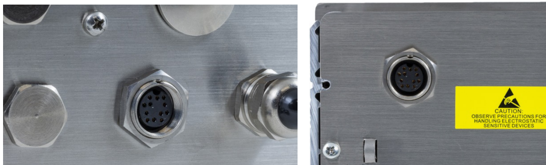
Abbildung 2-29: Lage des IDNet-Verbinders an dem Gehäuse für raue Umgebungen (links) und Frontplattengehäuse (rechts)
