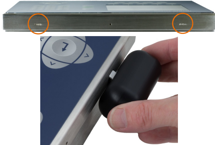
Abbildung 2-2: Gehäuse für raue Umgebungen öffnen, bevorzugte Methode
