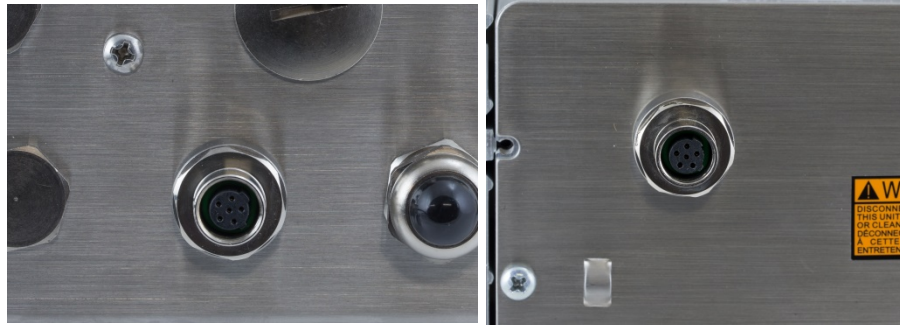
Figura 2-31: A Localização do Conector SICSpro nos Gabinetes para ambiente adverso (esquerda) e com Painel (direita)
