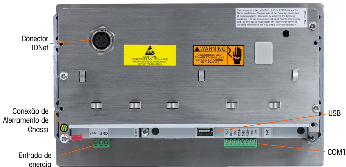
Figura 2-24: Conexões do Gabinete de Montagem em Painel, incluindo a Interface da Balança IDNet
