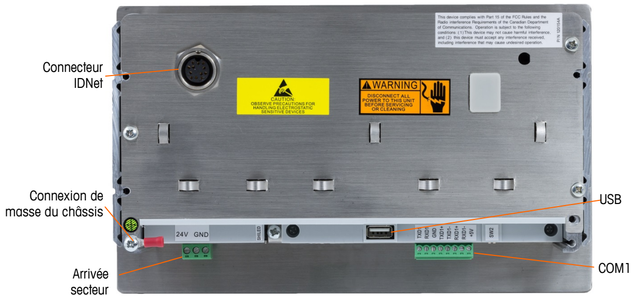
Figure 2-24 : Connexions de l'enceinte montée sur panneau, incluant l'interface pour bascule IDNet
