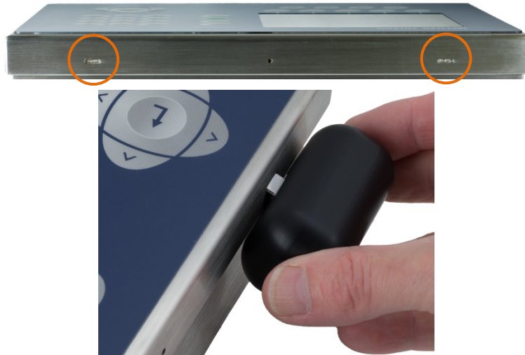
Figure 2-2 : Ouverture de l'enceinte pour environnement difficile, méthode privilégiée
