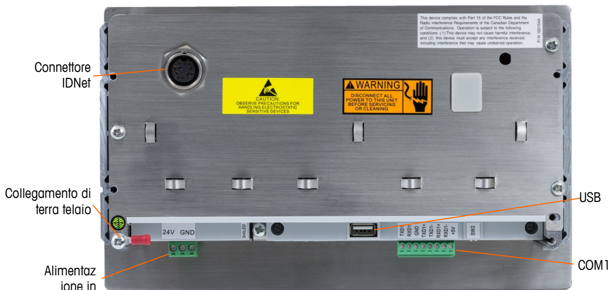
Figura 2-24: Collegamenti dell'armadietto con montaggio a pannello, tra cui interfaccia della bilancia IDNet
