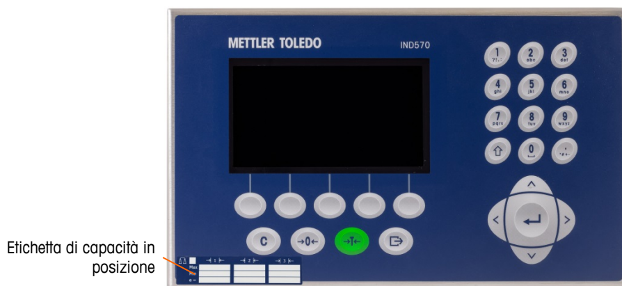
Figura 2-65: Etichetta di capacità installata
