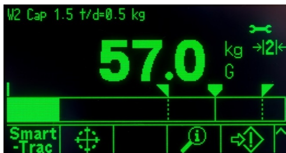
Figura 1-11: Trasferimento materiale di piccole dimensioni SmartTrac™ attivo
