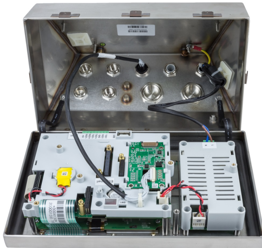
Figura 2-15: Pannello anteriore e connessione della cella di carico invertiti
