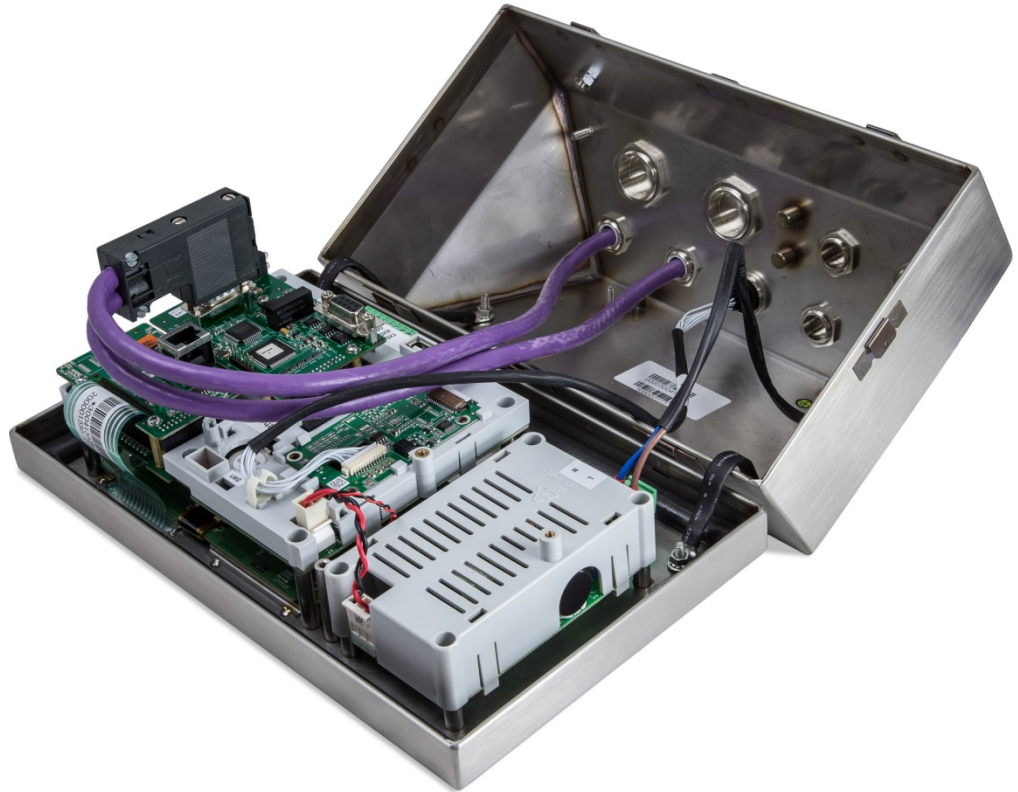
Abbildung 2-56: Verbindung des PROFIBUS-Kabels in dem Gehäuse für raue Umgebungen
