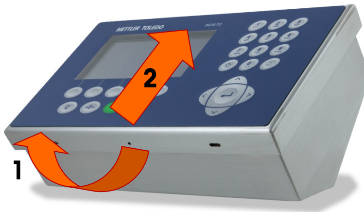
Figura 2-5: Remoção da tampa
