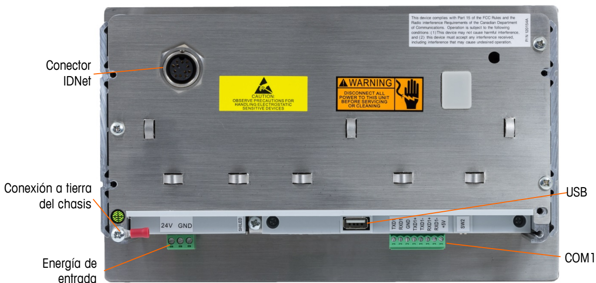
Figura 2-24: Conexiones de la caja para montaje en panel, incluyendo la interfaz de báscula IDNet
