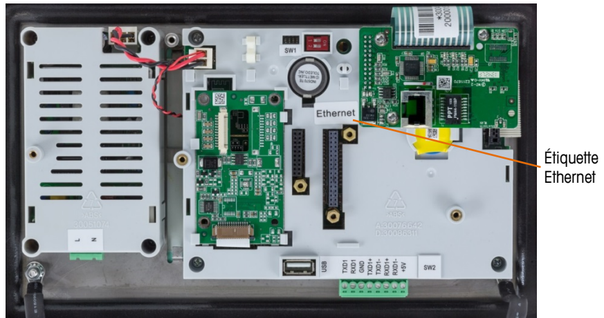
Figure 2-36 : Option Ethernet installée sur la carte principale
