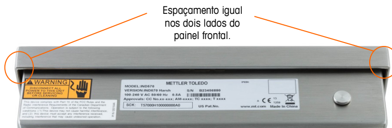
Figura 2-6: Painel Frontal do Gabinete para Ambiente Adverso Corretamente Alinhado
