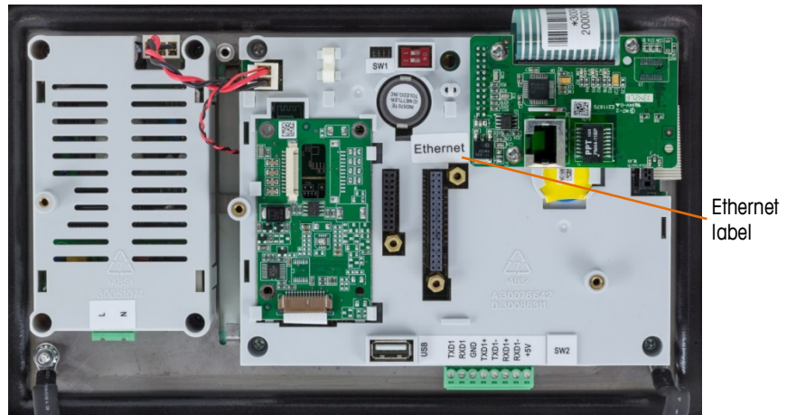
Abbildung 2-36: Ethernet-Optionsplatine auf der Hauptplatine
