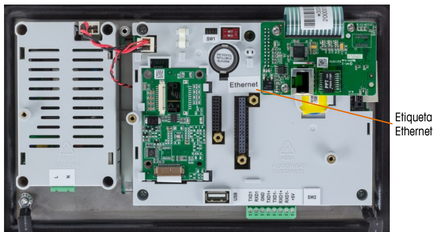
Figura 2-36: Opção Ethernet Instalada na Placa Principal
