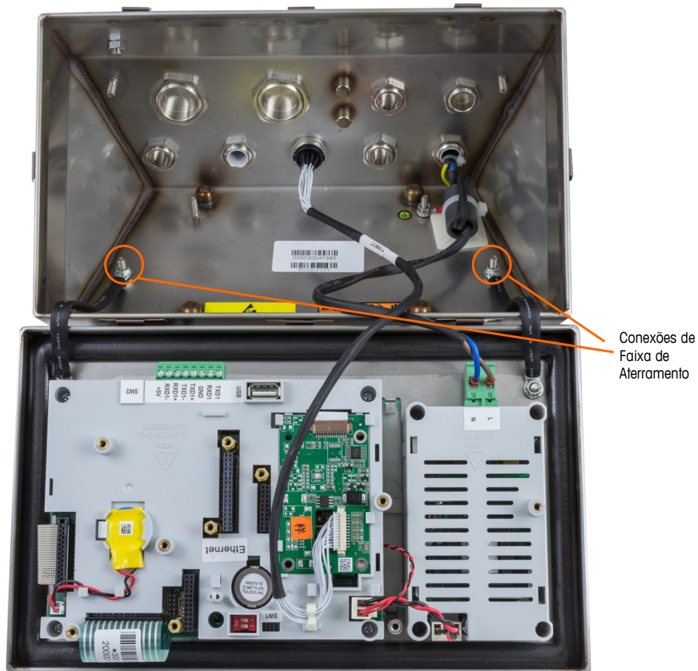
Figura 2-13: Solte as Faixas de Aterramento
