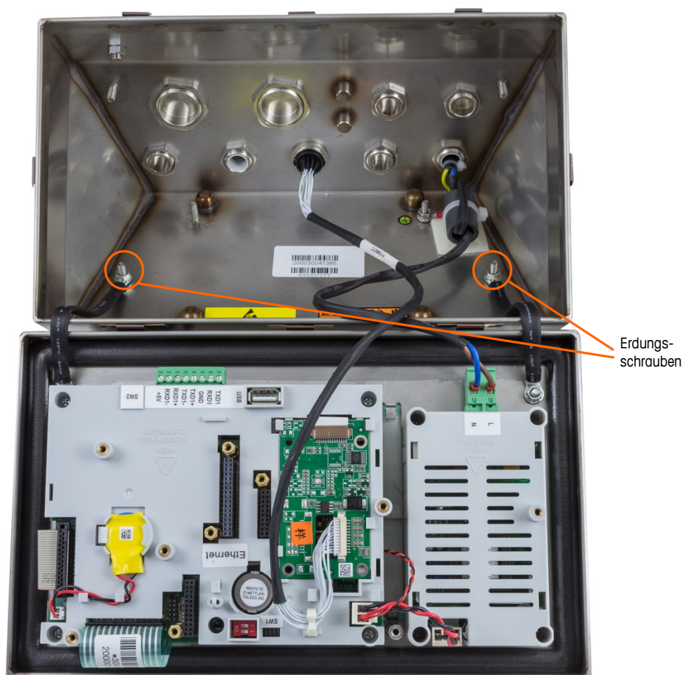
Abbildung 2-13: Lösen der Erdungsbänder
