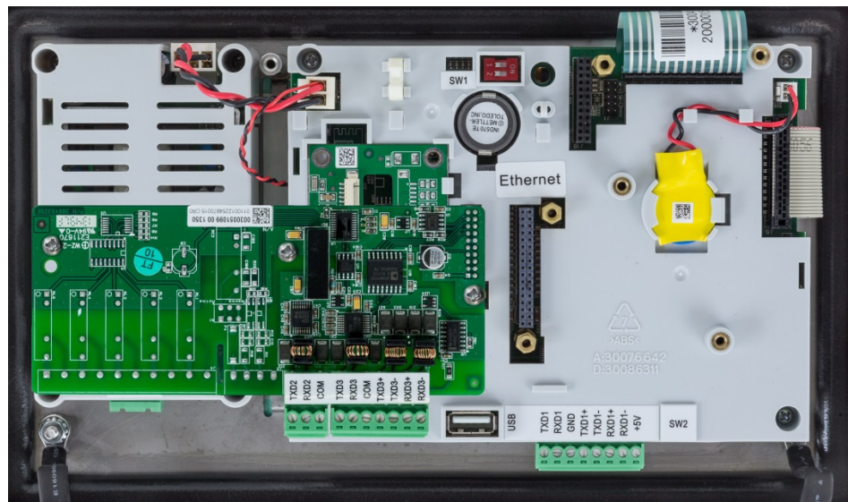
Figura 2-39: Placa de Opção COM2/3, Instalada
