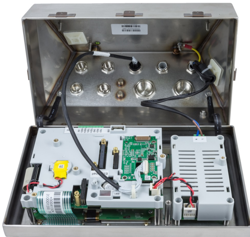
Figura 2-15: Painel Frontal e Conexão de Célula de Carga Revertidas
