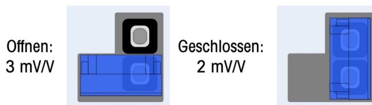
Abbildung 2-62: Positionen der Millivolt-Drahtbrücke W1
