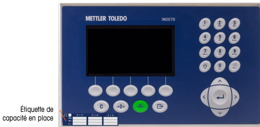
Figure 2-65 : Étiquette de capacité installée
