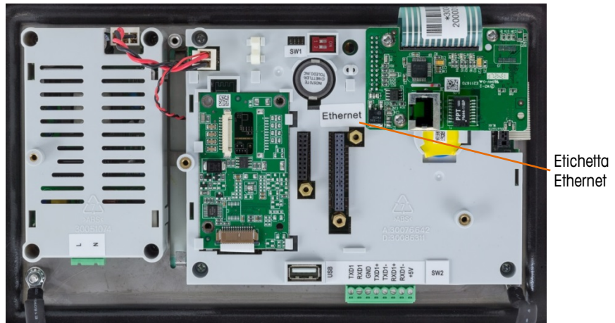
Figura 2-36: Opzione Ethernet installata sulla scheda principale
