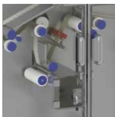
Acesso à Bobina Separada de Coleta Seletiva de Rejeitados
