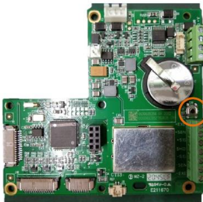
仪表主板上的计量设置开关位置
