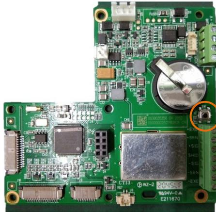
Figure 3-2 : Emplacement du commutateur de configuration sur la carte principale du terminal
