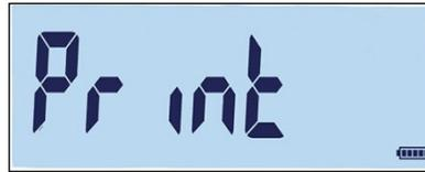
Figure 3-72 : Message d'impression de la configuration du terminal
