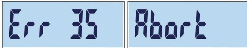
**Figure 3-17 : Messages d'erreur d'étalonnage de linéarité et d'annulation**
