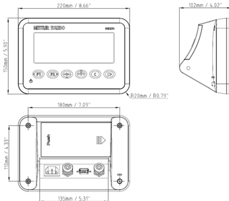
Figure 1-2 : Dimensions de l'enceinte de l'IND231
