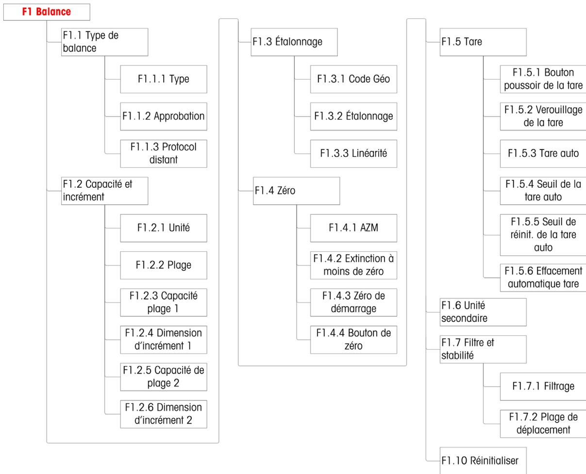
**Figure 3-8 : Structure du menu de la balance**
