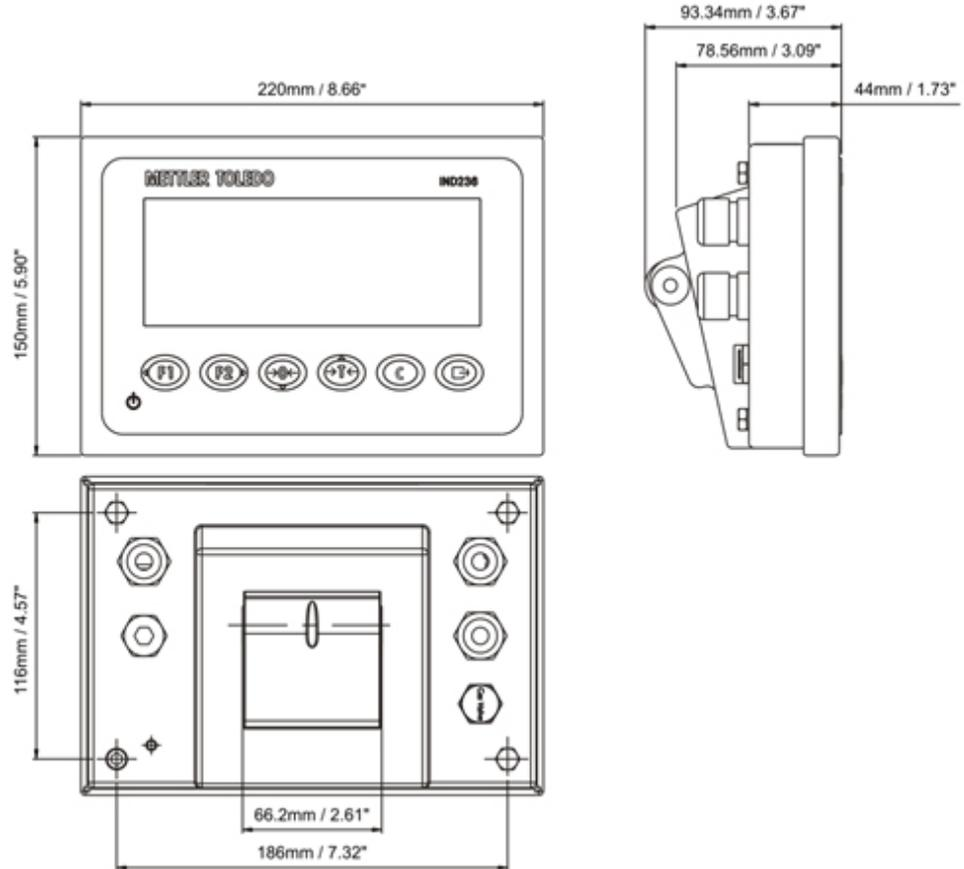
Figure 1-3 : Dimensions de l'enceinte de l'IND236
