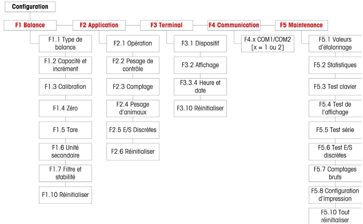
Figure 3-7 : Structure du menu de configuration IND231/IND236
