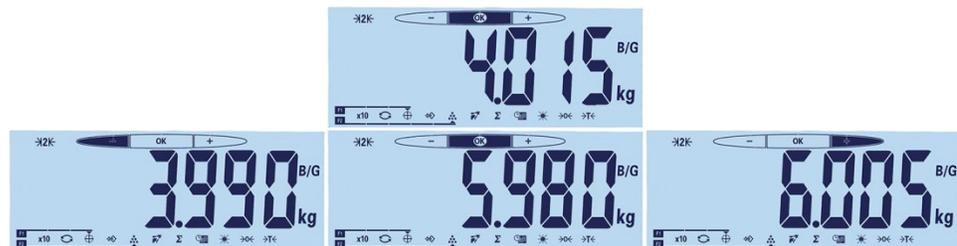
**Abbildung 2-13: Anzeige für Über, OK und Unter**
