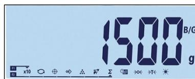
Abbildung 3-32: Anzeige der zweiten Maßeinheit
