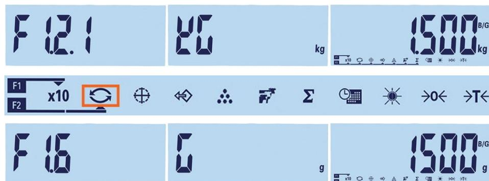
**Abbildung 2-7: Umschalten der Maßeinheit: Kilogramm in Gramm**
