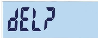
**Abbildung 3-51: Bildschirm zur Bestätigung des Löschvorgangs des Datensatzes**
