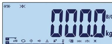
**Abbildung 3-27: Anzeige nach dem automatischen Löschen des Tarawertes**
