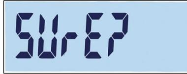
**Abbildung 3-36: Bestätigungsaufforderung zum Zurücksetzen des Waagenblocks**
