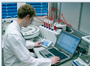
Système de titrage T90 - Rondo 60 – LabX pro titrage, dans le laboratoire de contrôle de la production, pour la détermination du nombre d'acide, de base et de saponification dans l'analyse d'une grande variété de lubrifiants.
