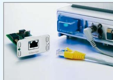
Connectez vos instruments METTLER TOLEDO directement à votre réseau. La version la plus récente des instruments est équipée de série d'un connecteur Ethernet prêt à l'emploi.
