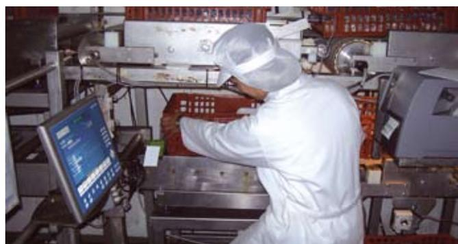
將包裝箱稱重與防護等級高達 IP69k 的重量顯示器和 PBA430 稱重平台安裝在一起
