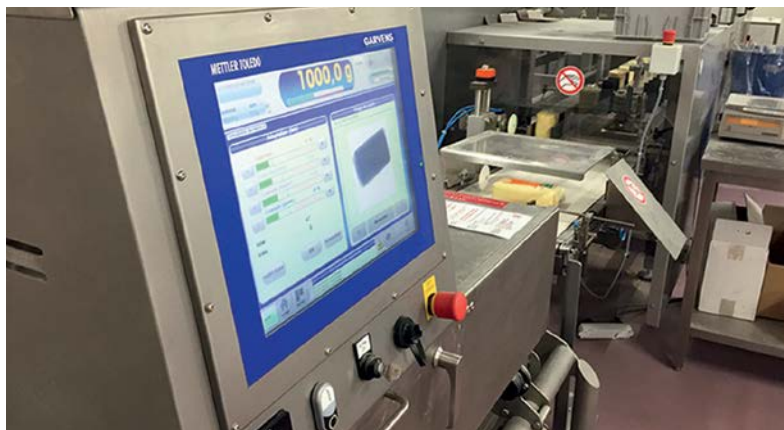
La tecnología de inspección de productos se usa para eliminar contaminantes y comprobar el peso del producto.
