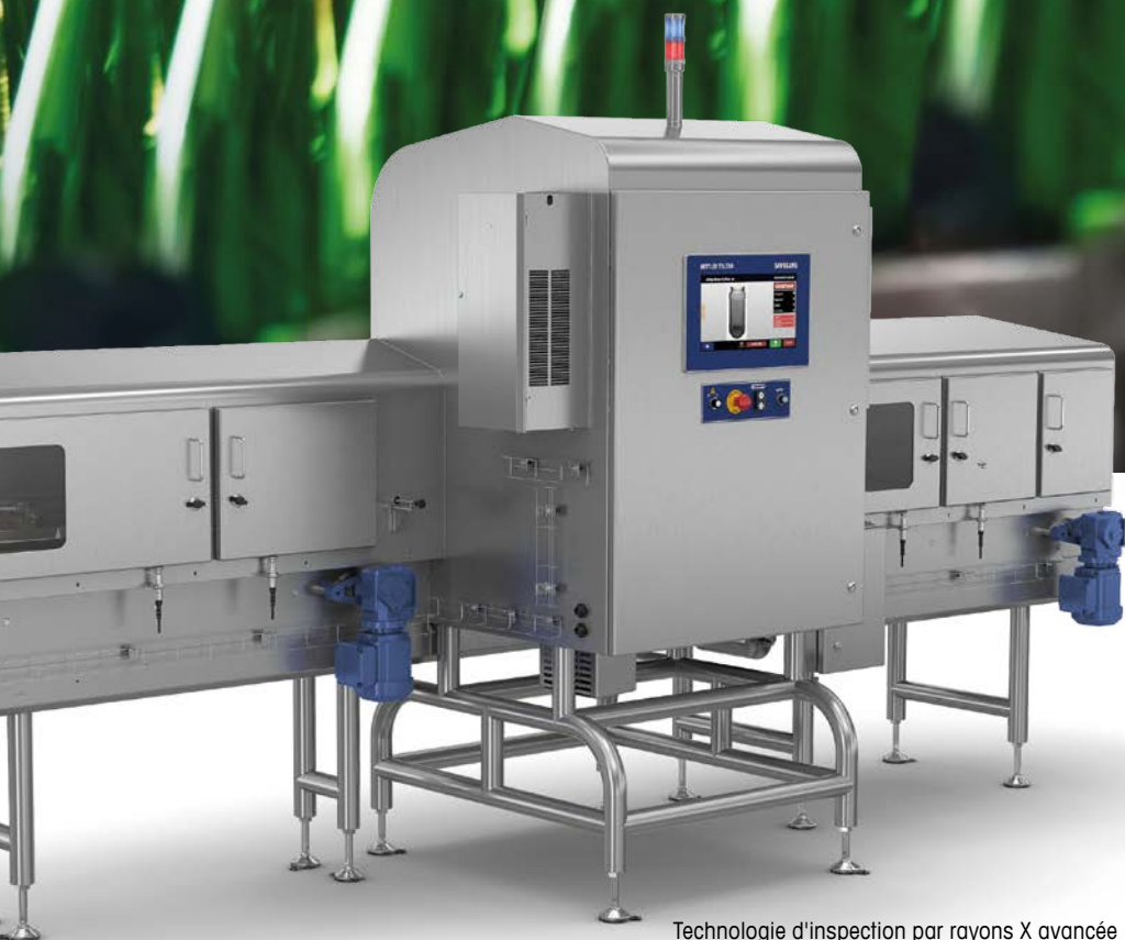
Technologie d'inspection par rayons X avancée pour la détection de contaminants (particules de verre dans un contenant en verre)
