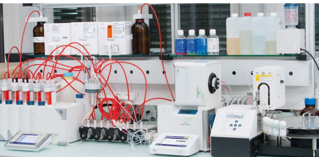
System wieloparametrowy: titrator T90, gęstościomierz DM40, czujnik indeksu refrakcji RX20 i moduł automatyczny SC30.
