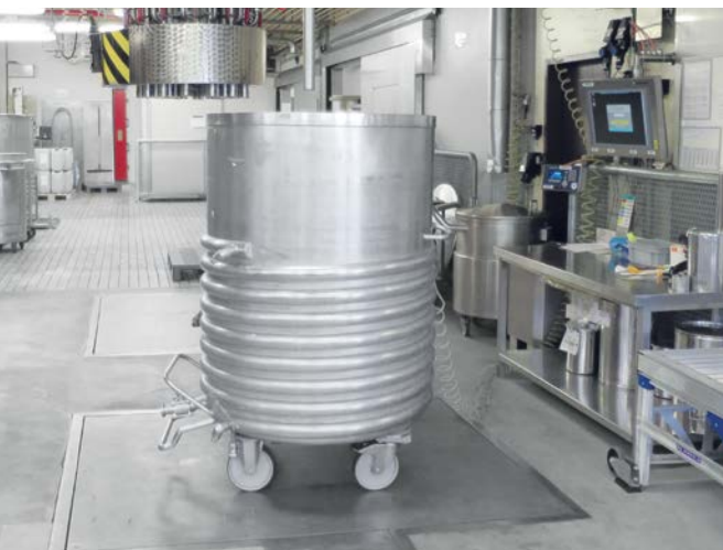
Zdjęcie powyżej przedstawia połączony system dozowania czterech materiałów na precyzyjnej wadze podłogowej.
