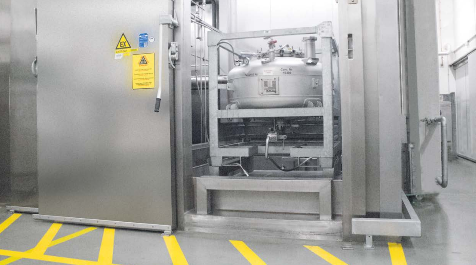
Zbiornik spoczywa na precyzyjnej wadze podłogowej zatwierdzonej do stref Ex, umożliwiającą dokładne dozowanie aldehydu octowego.
