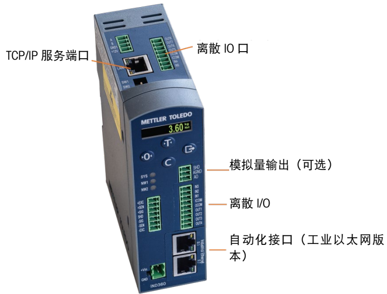
图 1-20: IND360 导轨式上的通信接口示例
