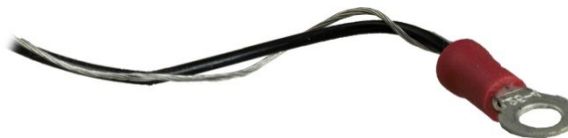
图 A-68: 环形仪表已压接到黑线和屏蔽线上
