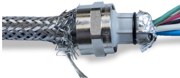
图 A-56：将内部编织屏蔽线和箔修剪到一定长度，然后向后折叠到索环上方
