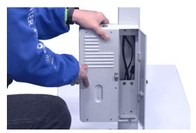
3 使用四个 M4 盘头螺钉固定电子模块。工具: 十字头螺丝刀
