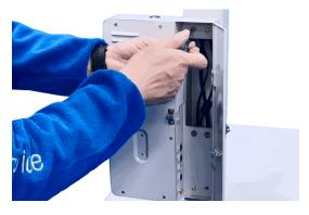
4 将摄像头和显示屏电缆连接至 USB 和 HDMI 接口。请参见[连接能力 ▶ 第4页]了解更多信息。
