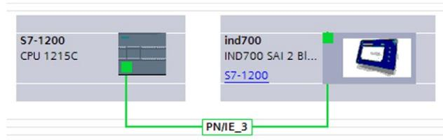
图 3-26: 在网络视图中添加 PROFINET 设备
