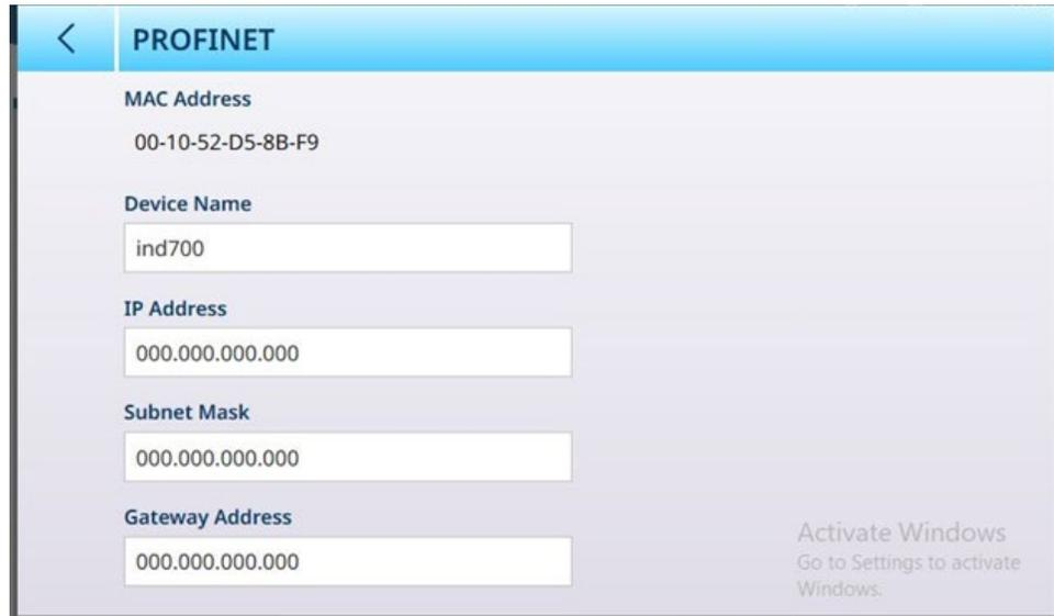
图 3-14: IND700 设置屏幕中的 PROFINET MAC 地址
