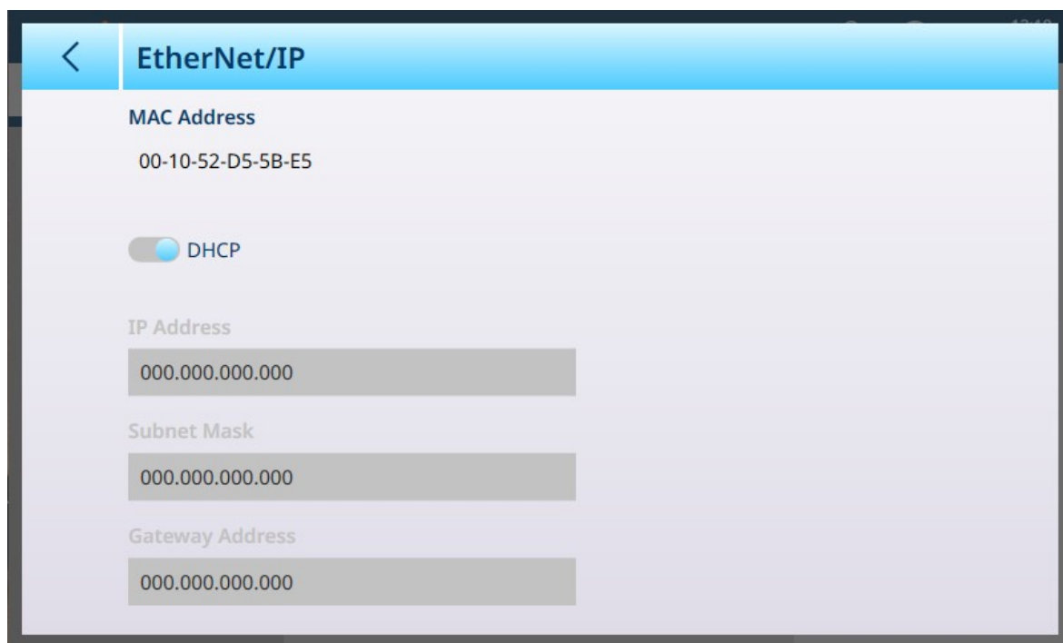
图 338: EtherNet/IP 工业以太网接口配置
