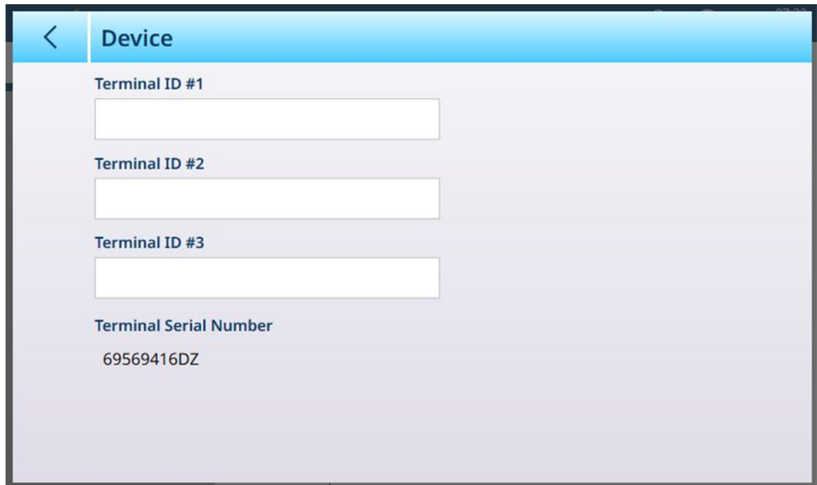
图 413: 仪表 > 显示序列号的设备屏幕
