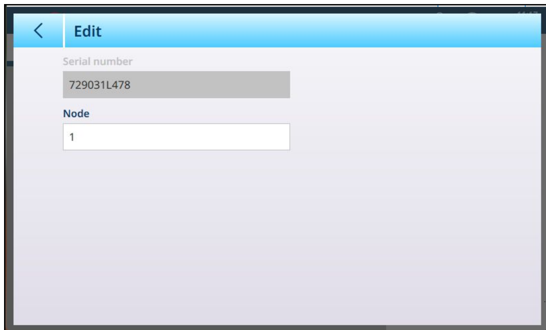
图 148: 称重传感器地址编辑对话框
