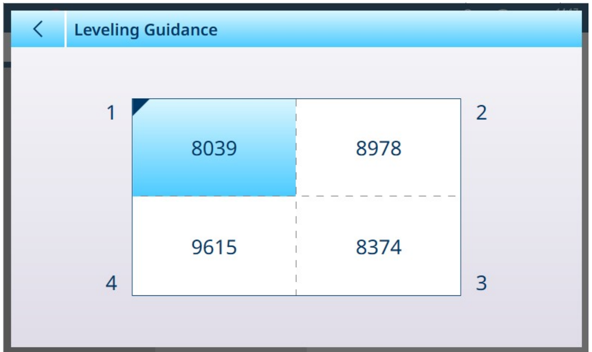
图 204: 调平指导屏幕，4 个称重传感器
