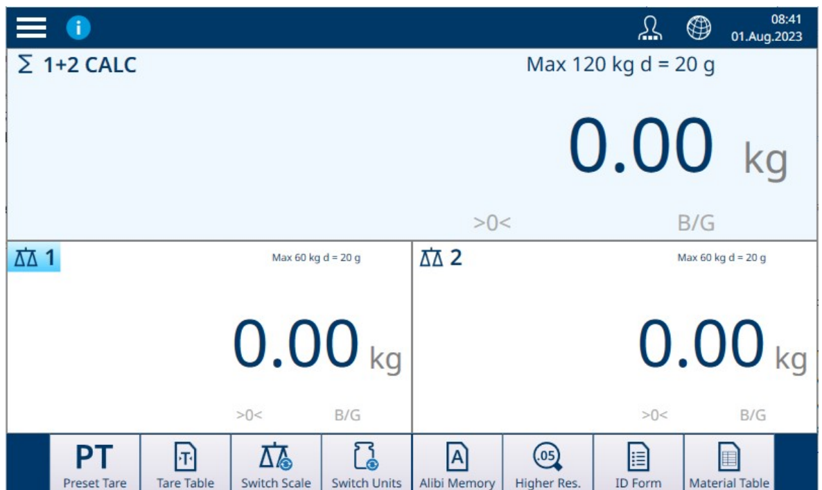
图 51: 显示两台 HSALC 秤和一台求和秤的 IND700
