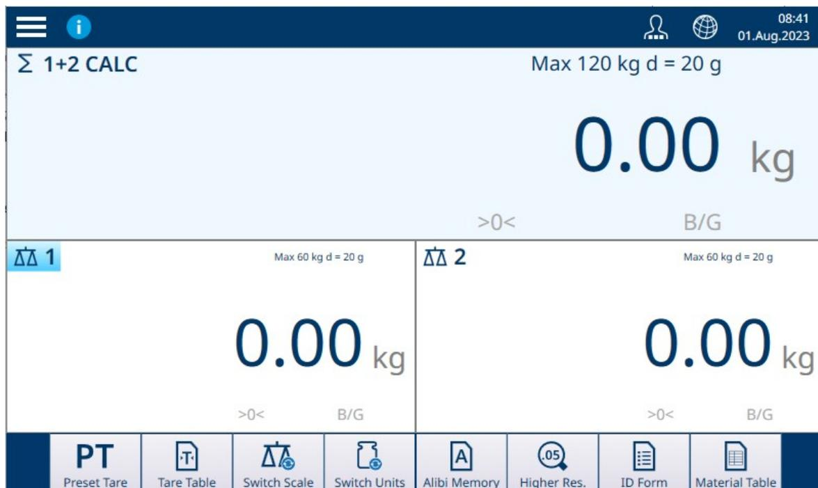
Figura 51: IND700 que Exibe Duas Balanças com HSALC e uma Balança Somadora
