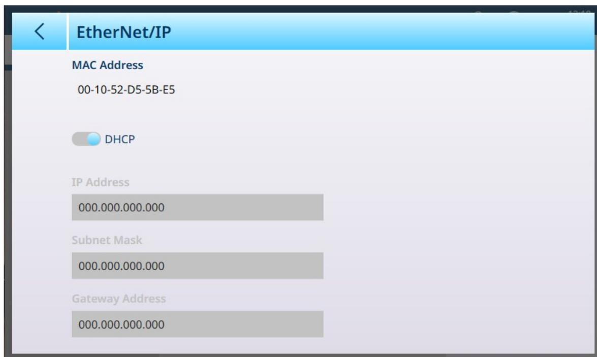
Figura 338: Configuração da Interface Rede Industrial EtherNet/IP
