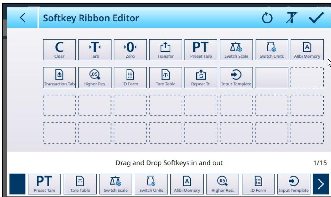
Figura 291: Tecla de Função Editor de Fita: Teclas de Função Exibidas com Etiquetas – Padrão
