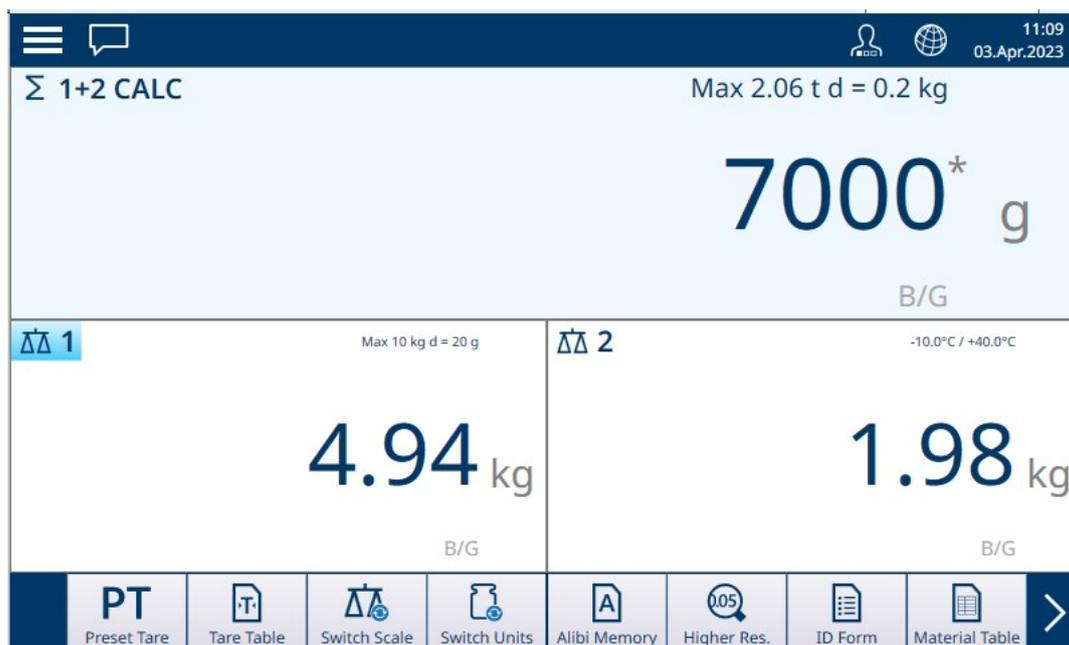
Figura 83: Exemplo de Display de Pesagem Simples
