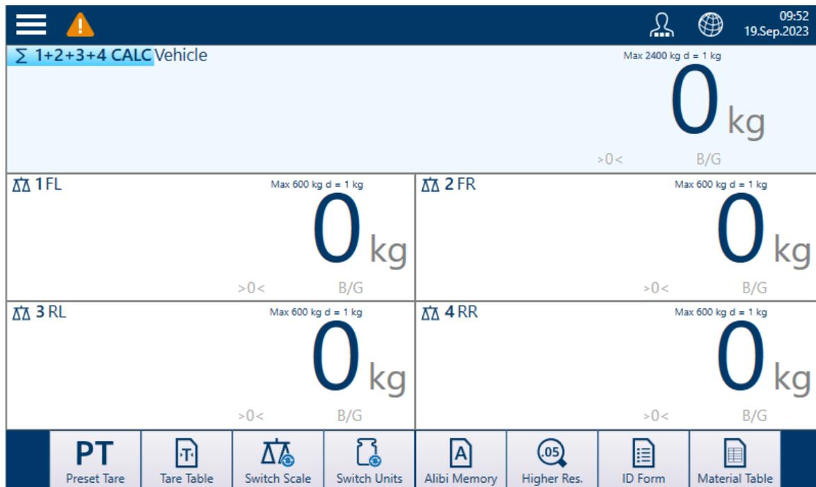
Figura 167: Display de Peso – Quatro Balanças e Balança Somadora
