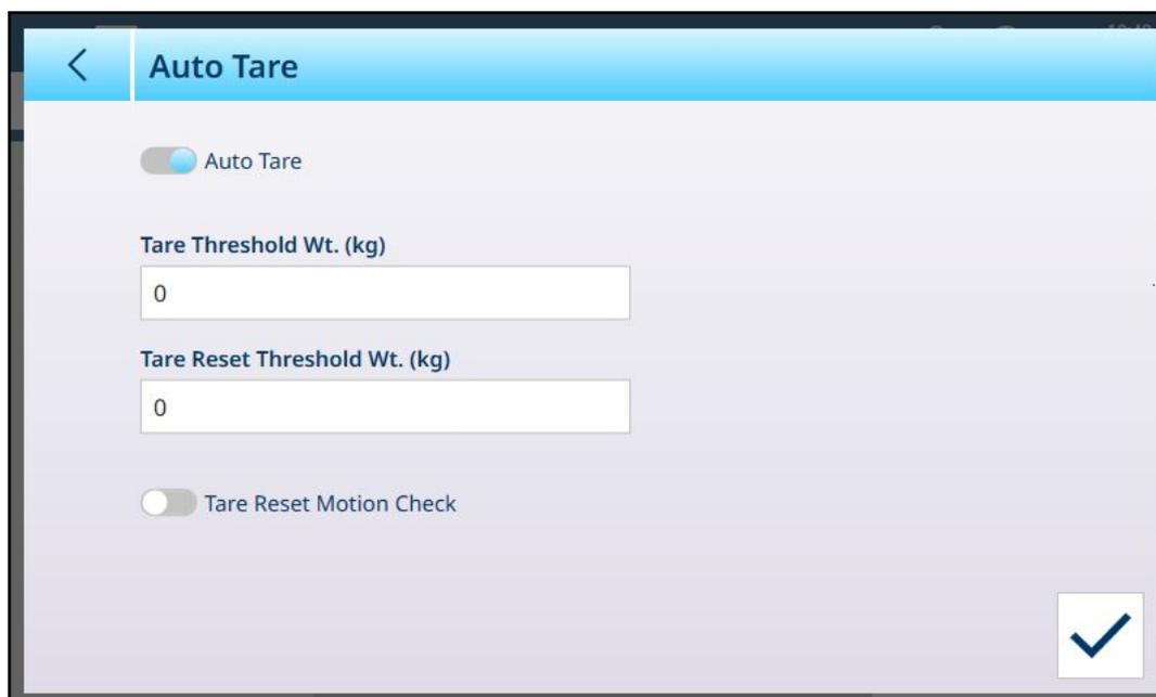
Figura 246: Balança Somadora – Tara: Tara Automática Ativada
