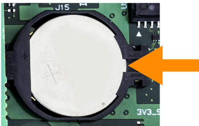
Figura 435: Remoção da Bateria
