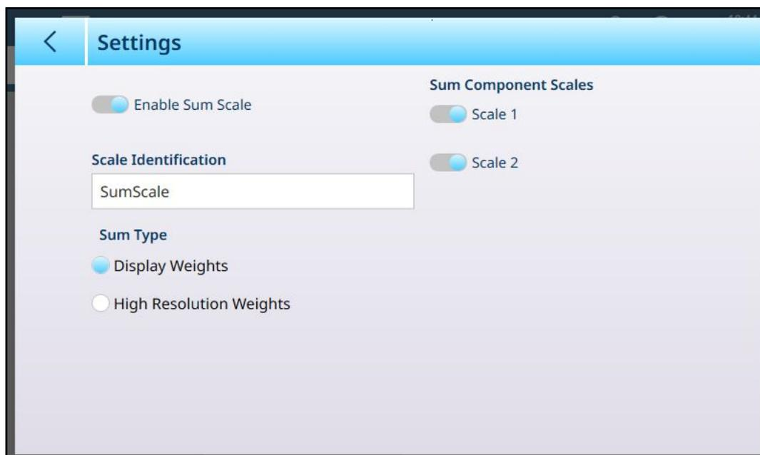
Figura 238: Configurações da Balança Somadora
