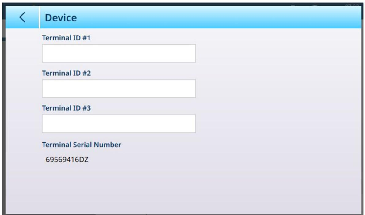
Fig. 413: Écran Terminal > Appareil affichant un numéro de série
