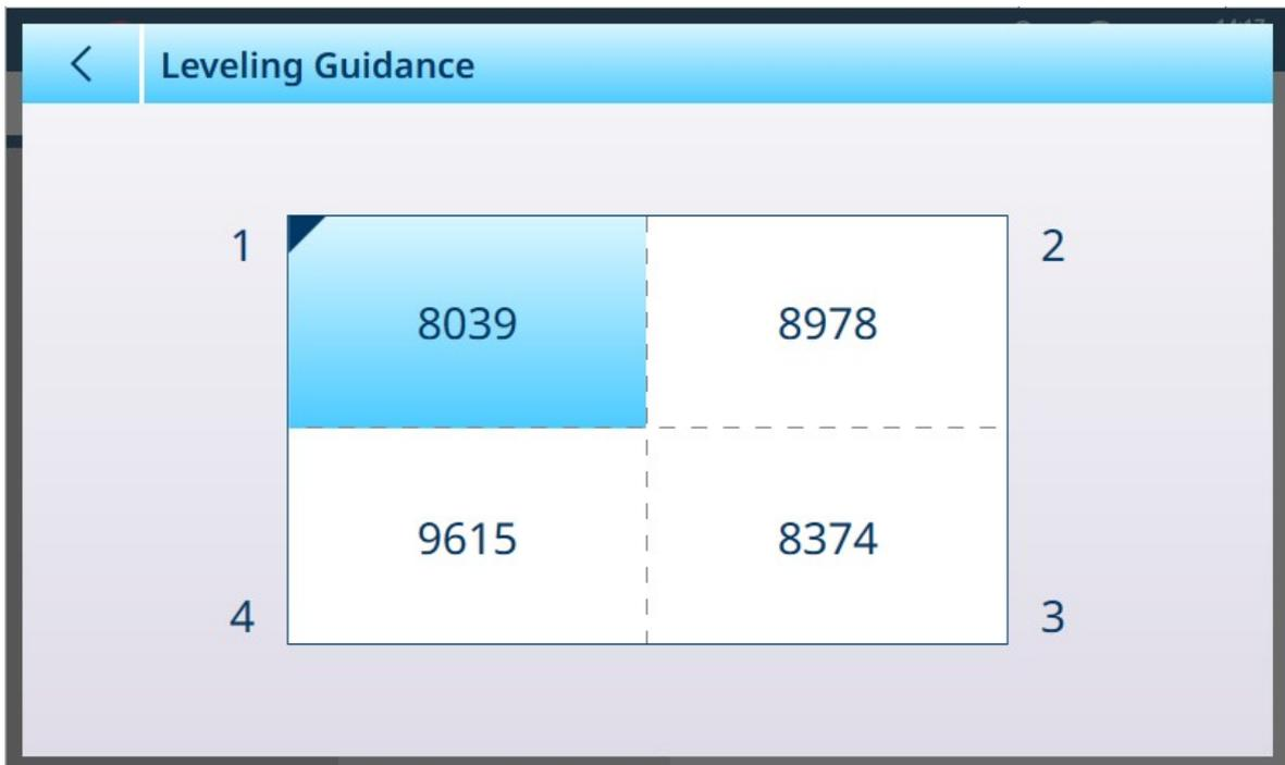
Fig. 204: Écran de guidage de niveau, 4 capteurs
