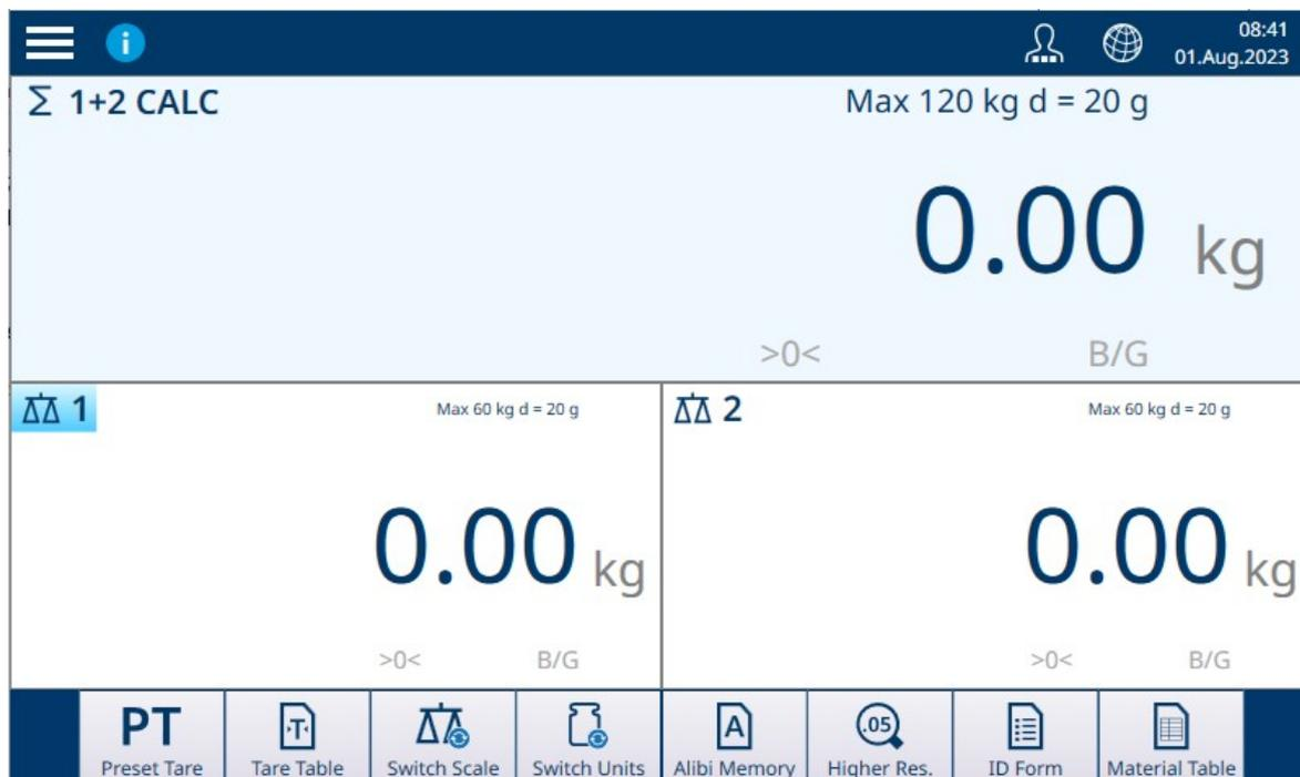
Fig. 51: Terminal IND700 affichant deux balances HSALC et une balance de somme
