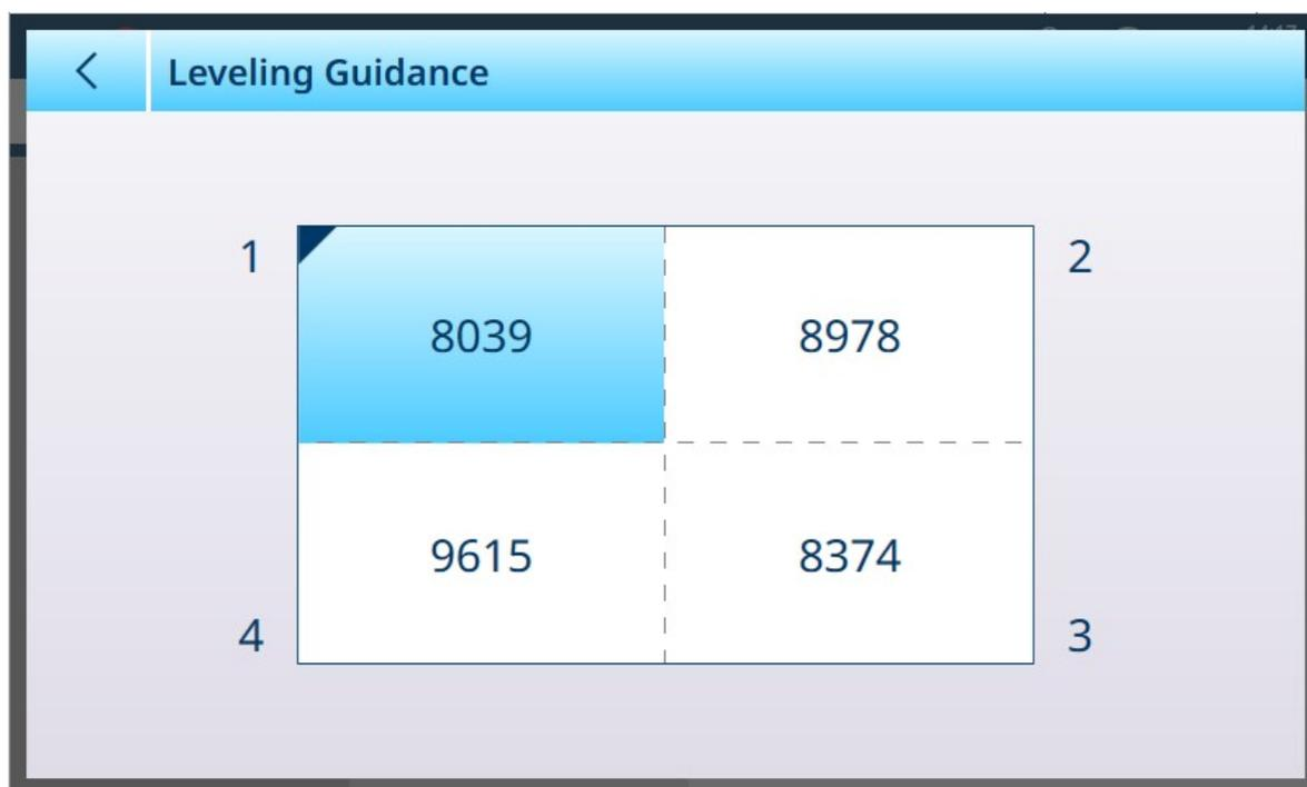
Fig. 436: Guidage de niveau, balance à 4 capteurs de force
