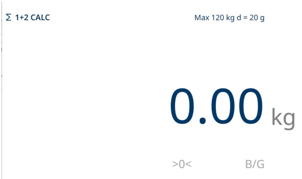
Fig. 52: IND700 centrado en una de las tres áreas de la pantalla de peso
