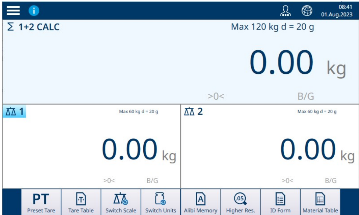
Fig. 51: IND700 con dos básculas HSALC y una báscula de suma
