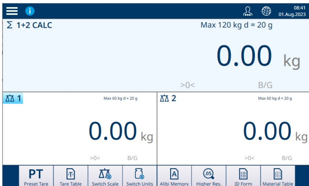
Abb. 51: IND700 mit Anzeige von zwei HSALC-Waagen und einer Summenwaage
