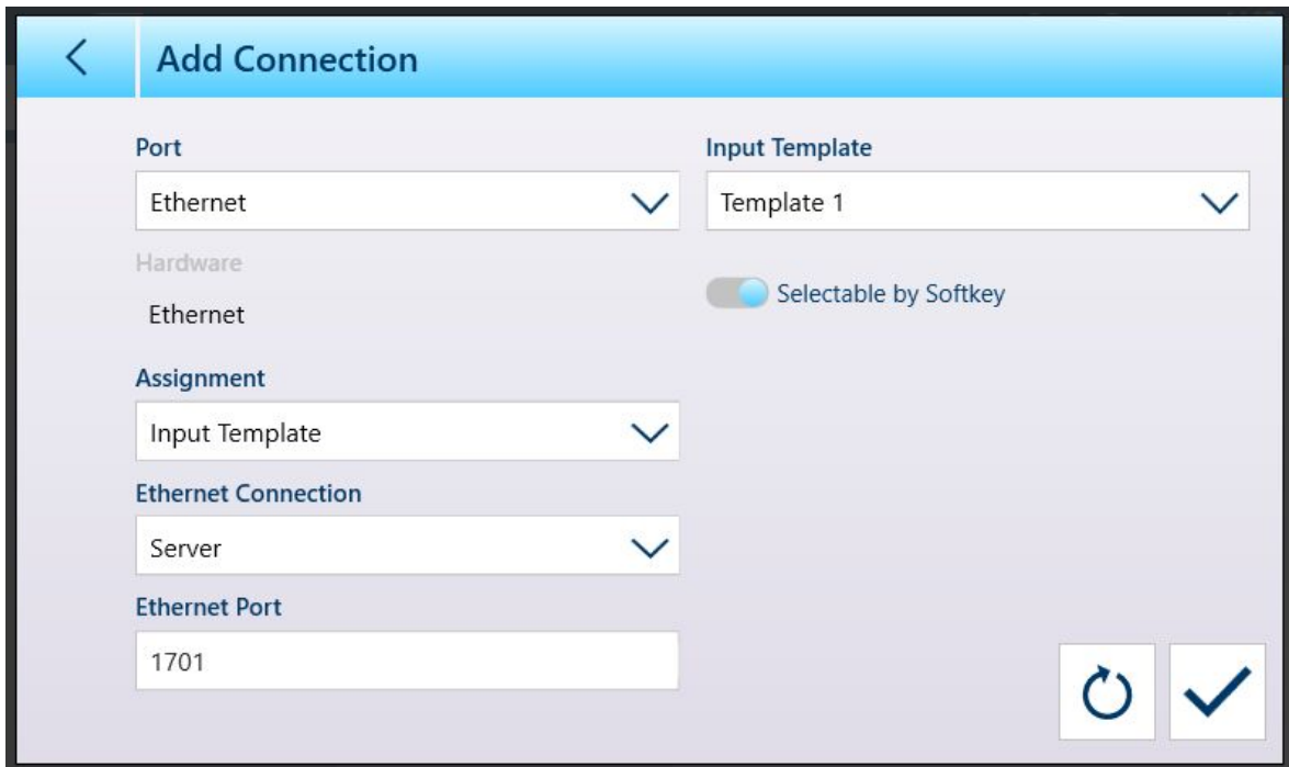
Abb. 328: Neue Verbindung, Zuweisung der Eingangsvorlage
