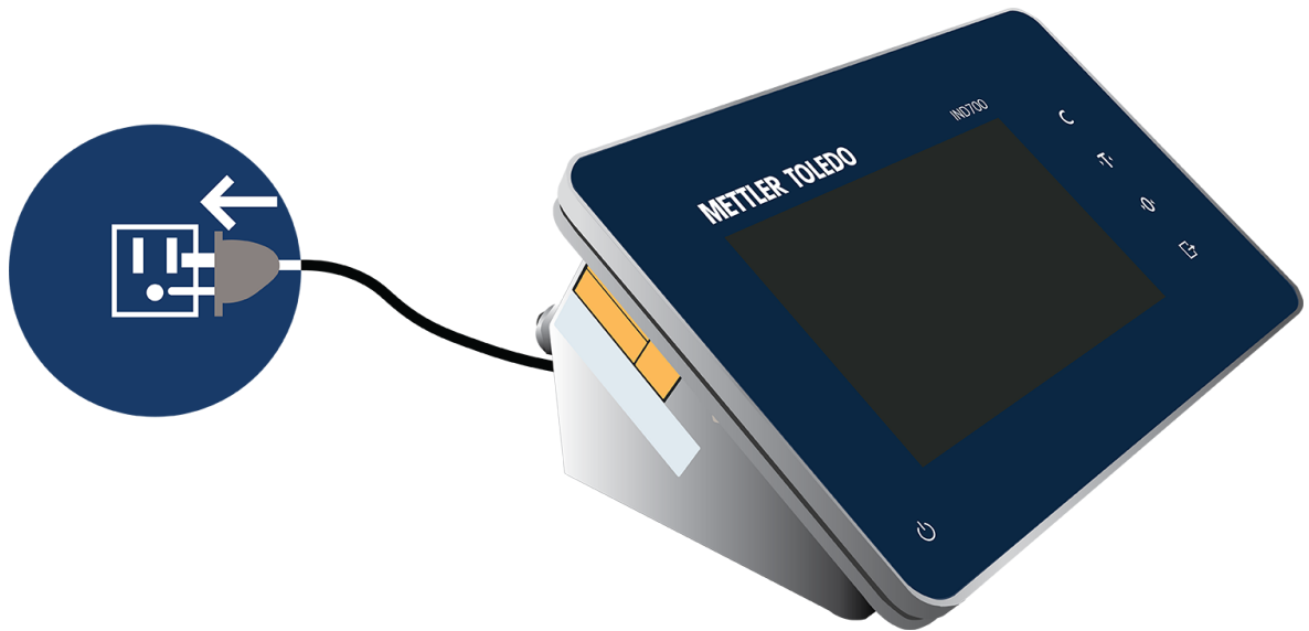
Abb. 23: Anschluss des Terminals an die Stromversorgung
