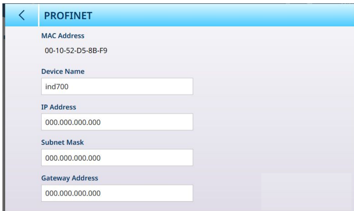
Abb. 337: PROFINET Industrial Ethernet-Schnittstellenkonfiguration
