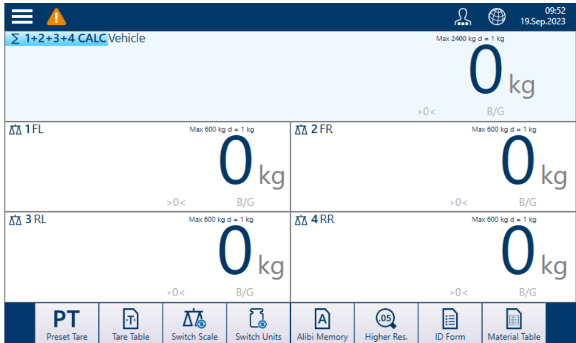
Abb. 167: Gewichtsanzeige – vier Waagen und Summenwaage
