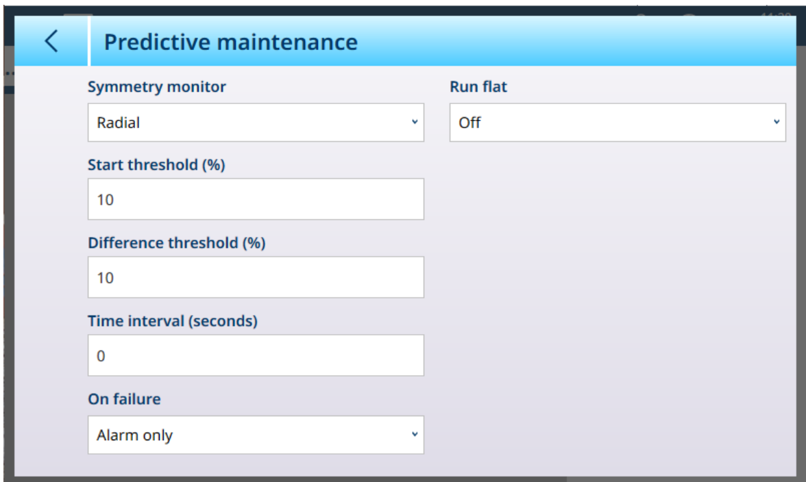
Abb. 194: POWERCELL Wartung – Vorausschauende Wartung
