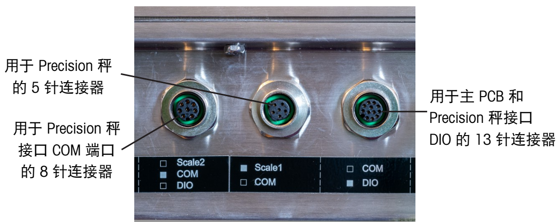
图 47: 与 Precision 接口板相关的外部 M12 连接器
