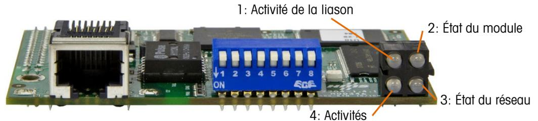
Figure 4-3 : DEL d'indication de l'état Ethernet/IP
