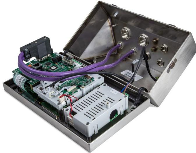
Figure 6-6 : Carte d'option PROFIBUS installée - Enceinte pour conditions difficiles
