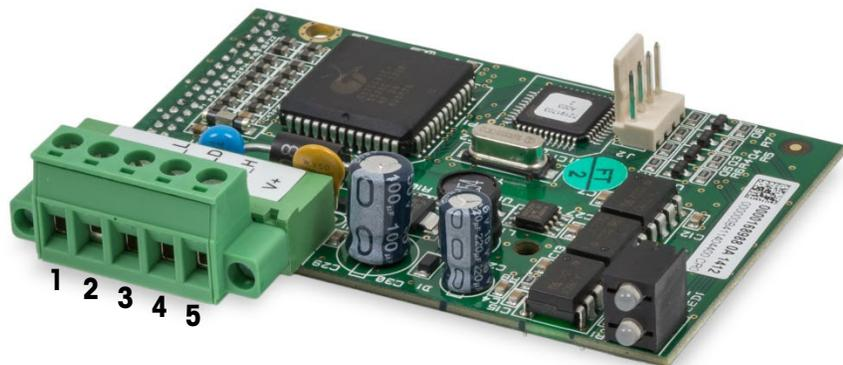
Figure 3-2 : Numérotation du brochage du connecteur DeviceNet
