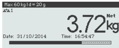
Der Balken zeigt ungefähr an, welcher Anteil der Waagenkapazität bereits belegt ist und welche Kapazität noch zur Verfügung steht.
