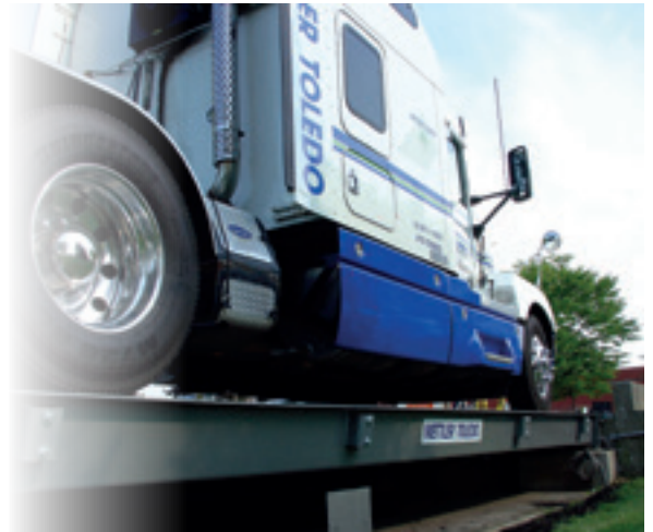
Las básculas están disponibles en prácticamente cualquier configuración o capacidad de pesaje, y pueden instalarse en el suelo o por encima de este.
