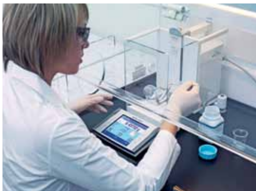
Fig. 10: Cabine de pesage sécurisée avec balance analytique Excellence Plus.
