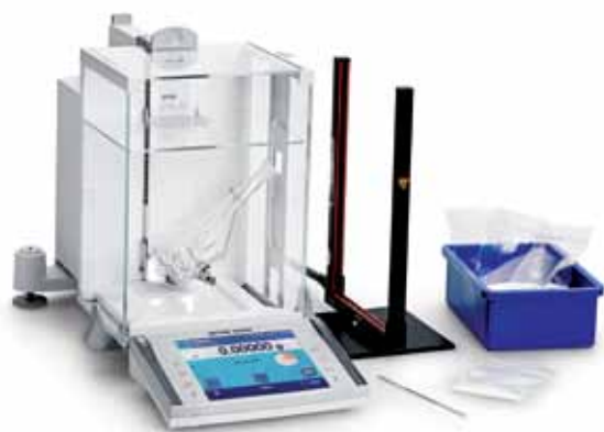
Fig. 5: Balance analytique Excellence Plus XP205 avec kit antistatique universel. L'électrode en U placée à l'avant de la porte de la balance présente la taille idéale pour décharger tous types d'échantillons et de récipients de tare. Le kit antistatique universel peut être utilisé sur tous types de balances.
