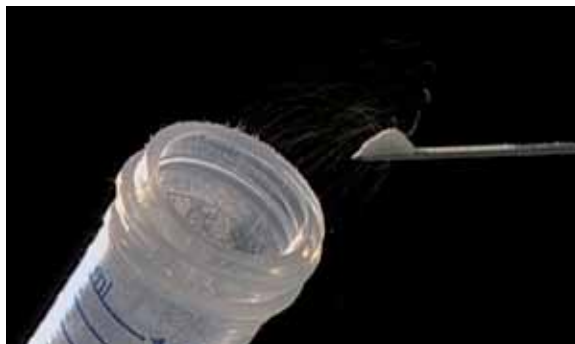
Fig. 8: Opération de pesage - Poudre « sautant » à cause des charges électrostatiques.
