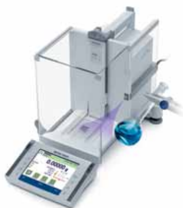
Fig. 7: Balance analytique Excellence Plus XP205 avec kit antistatique intégré. Grâce au kit antistatique intégrable sur les balances analytiques XP et les microbalances, le processus de déchargement est synchronisé avec l'ouverture de porte automatique. L'électrode ponctuelle se déclenche automatiquement lorsque la porte s'ouvre et s'éteint lorsque la porte se ferme.
