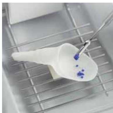
Fig. 2: Entonnoir pour pesée SmartPrep, exemple d'instrument de pesage en plastique avec propriétés antistatiques.
