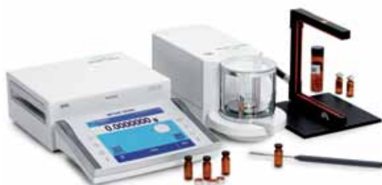
Fig. 6: Microbalance Excellence Plus XP2U ou comparateur XP6U avec kit antistatique micro. La petite électrode en U est idéale pour décharger de petits échantillons, les filtres et les récipients de tare.
