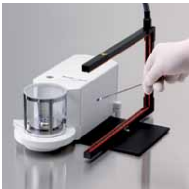
Fig. 9: Décharge d'échantillon lors d'un dosage manuel sur une microbalance. La petite électrode en U est idéale pour décharger de petits échantillons et récipients de tare.
