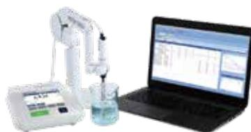
EasyDirect pH 軟體，可直接有效率的管理pH, 電導度, 溶氧...數據，可直接連接梅特勒托利多多款酸鹼度計，是您數據收集的好幫手
