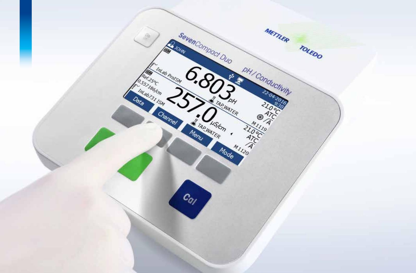
SevenCompact™ 系列分為3種機型，適用於各種應用，它不僅可以測量酸鹼度、離子濃度及導電率，針對導電率換算的相關資訊，例如TDS、鹽度、電阻率及電導度灰分也可取得。
