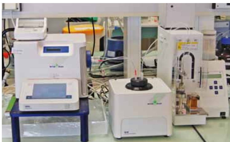
Le système LiquiPhysics, équipé d'une unité d'automatisation SC1, traite entre 20 et 30 échantillons par jour.
