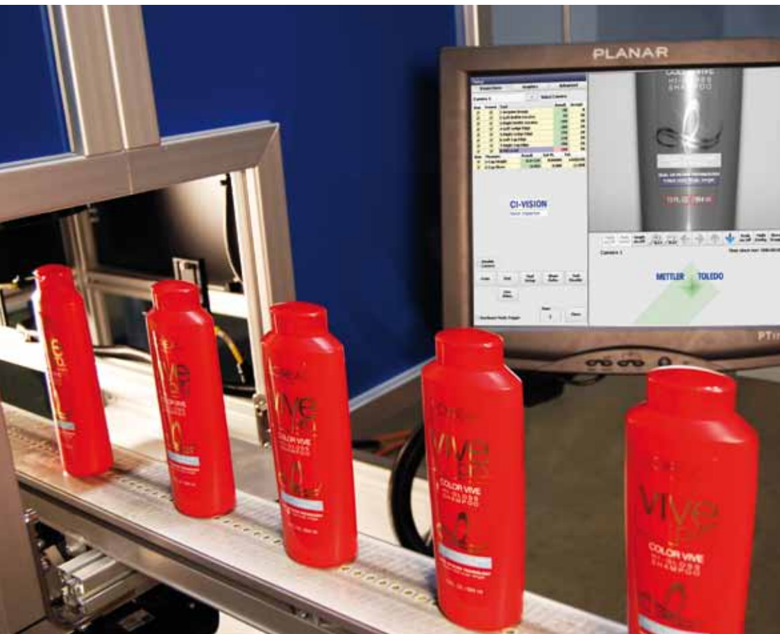
L'Oréal utilise un système couleur à 2 caméras et un lecteur code-barre
