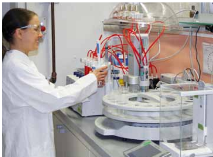
Kathrin Uennigmann charge un échantillon pour déterminer son indice de peroxyde.
