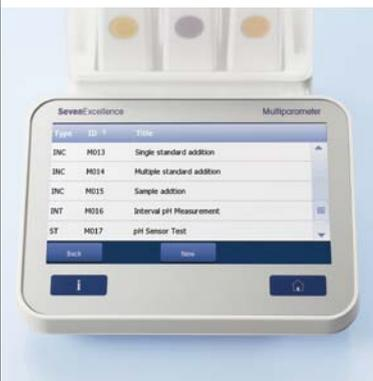
Des méthodes spéciales sont également incluses pour les techniques de mesure de concentration ionique par incréments les plus courantes, comme différentes méthodes d'ajout/de soustraction d'étalon et d'échantillon. Vous disposez ainsi d'un ensemble d'outils polyvalents et modernes pour effectuer des mesures professionnelles de concentration ionique !
