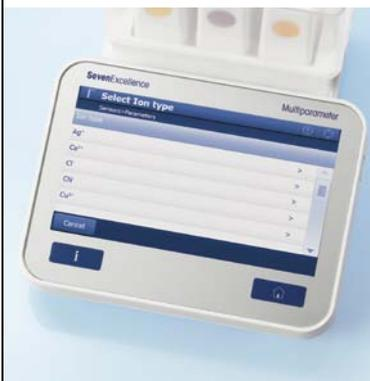
Les douze types d'ions les plus fréquemment utilisés sont pré-programmés dans l'instrument pour faciliter au maximum les réglages. Pour les autres ions, il vous suffit de saisir la charge ionique et la masse molaire et l'appareil effectuera pour vous l'ensemble des calculs et des conversions.
