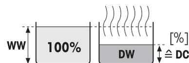
Durante la misurazione, il valore viene costantemente visualizzato in percentuale e, a livello grafico, tramite la curva di essiccamento. Il valore misurato è contrassegnato dal simbolo "%DC" (Contenuto Secco, ad esempio 88,65 %DC) anche in versione stampata.
