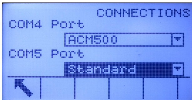
Figura 3-12: Conexión del COM4 configurado para el ACM500
