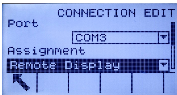
Figura 3-13: Conexión del COM2 y COM3 configurada para operación remota
