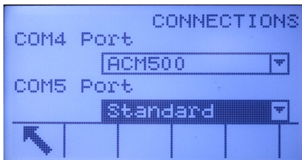
Figura 3-14: Conexión del COM4 o del COM5 configurada para convertidor de fibra óptica o ACM200
