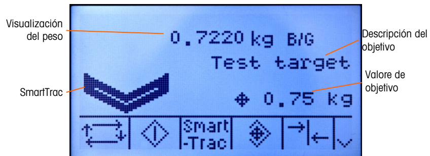
Figura 2-19: Pantalla sobra/falta de tamaño mediano
