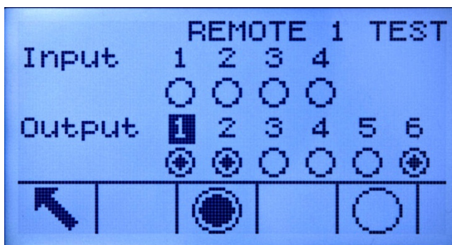
Figura 4-5: Pantalla de prueba de E/S discontinuas
