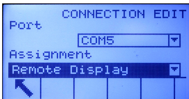
Figura 3-15: Conexión del COM4 o del COM5 configurada para operación remota
