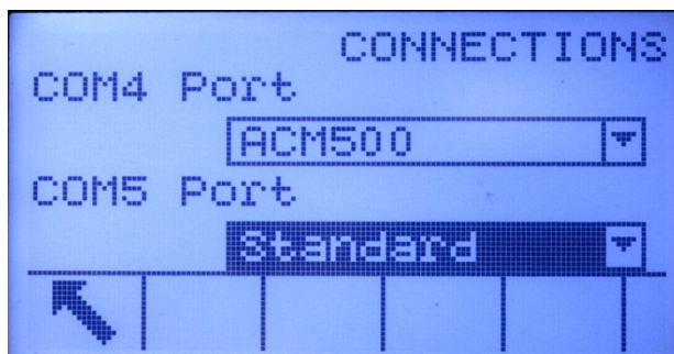
Figura 3-12: Connessione COM4 configurata per l'ACM500
