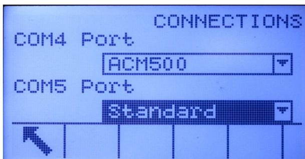
**Figure 3-12: Connexion COM4 configurée pour l'ACM500**
