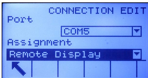
Figure 3-15: Connexion COM4/COM5 configurée pour une opération distante
