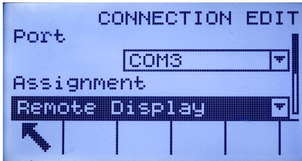
Figure 3-13: Connexion COM2/COM3 configurée pour une opération distante
