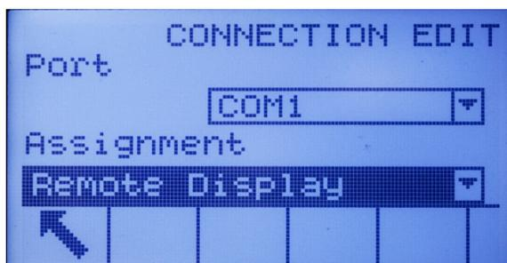
**Figure 3-11: Connexion COM1 configurée pour une opération distante**
