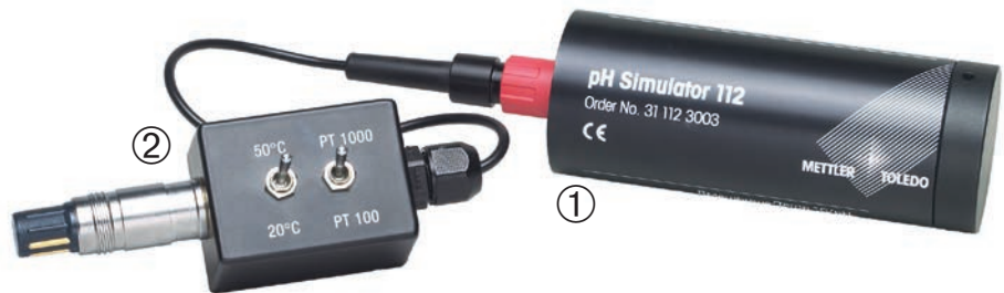
pH 아날로그 검증 키트: pH 시뮬레이터 112와 통합 ① VP 시뮬레이터 포함 ② pH 및 온도 신호를 시뮬레이션하여 트랜스미터의 자동 온도 보상 기능을 확인할 수 있습니다.
