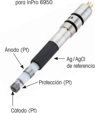
Conjunto ánodo/cátodo sustituible para InPro 6950
