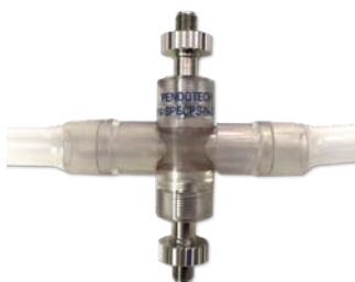
Acopladores ópticos instalados en la célula de flujo
