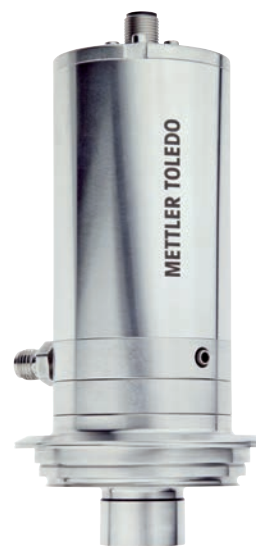
Fig 2: El sensor de CO 2 disuelto en línea InPro 5500i de METTLER TOLEDO utiliza mediciones de conductividad térmica.
