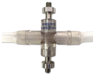
An der Durchflussmesszelle installierte optische Koppler
