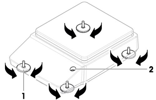
➔ La balance est mise de niveau et soutenue par les quatre pieds de mise de niveau.
