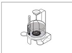
Kit para determinação de densidade de sólidos e líquidos (para modelos de 1 mg e 0,1 mg)
