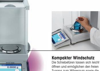
öffnen und ermöglichen den freien Zugang zum Wägeraum sowie die einfache Reinigung. Sie ragen nie über die Wagenrückseite hinaus, was wertvollen Platz spart.
