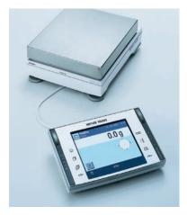
Abnehmbares Terminal, ebene Flächen: die XP ist einfach zu reinigen. Waagschale und Windring sind gar spülmaschinenfest. Abgedichtete Schnittstellen, verschraubtes Stromkabel. Da dringen weder Wasser noch Staub ein – für Schutz nach IP54 im Einsatz.
