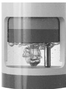
Nettoyage de la sonde avec de l'air grâce à un effet de cavitation.
