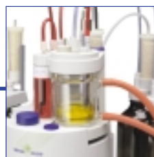
恒温滴定杯 含内外两层杯壁，使滴定不受外界温度影响。
