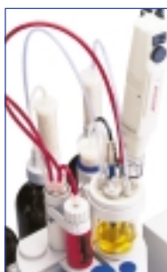
均质器 在滴定池内直接搅拌样品。
