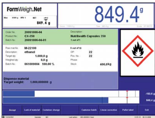
FormWeigh.Net®配料站软件可以让您一眼看见所有的关键物料项信息，包括譬如显示物料危害性的图标。
