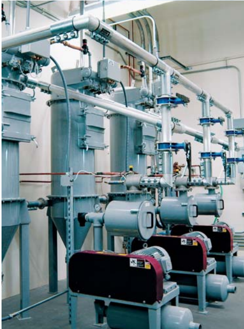
大容量的载货机自动将原材料送入制模机
