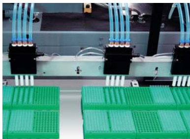
机械臂自动吸头装载系统，消除人工污染
