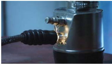
SLC820在模拟雷击波形下测试
